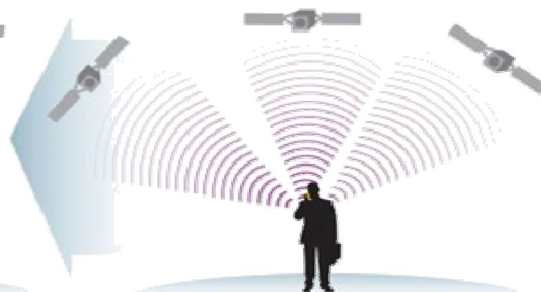
Cuando se quiere determinar o saber una posición, el receptor localiza mínimo tres satélites de la red, de los que recibe señales y el aparato se sincroniza con el reloj de cada uno de ellos.
